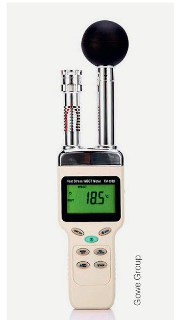
Zur Bestimmung des WBGT-Index werden die Luftfeuchtigkeit mit einem Kolben («Wet Bulb») und die Temperatur bei direkter Sonneneinstrahlung im Inneren einer schwarzen Kugel («Globe») gemessen.
